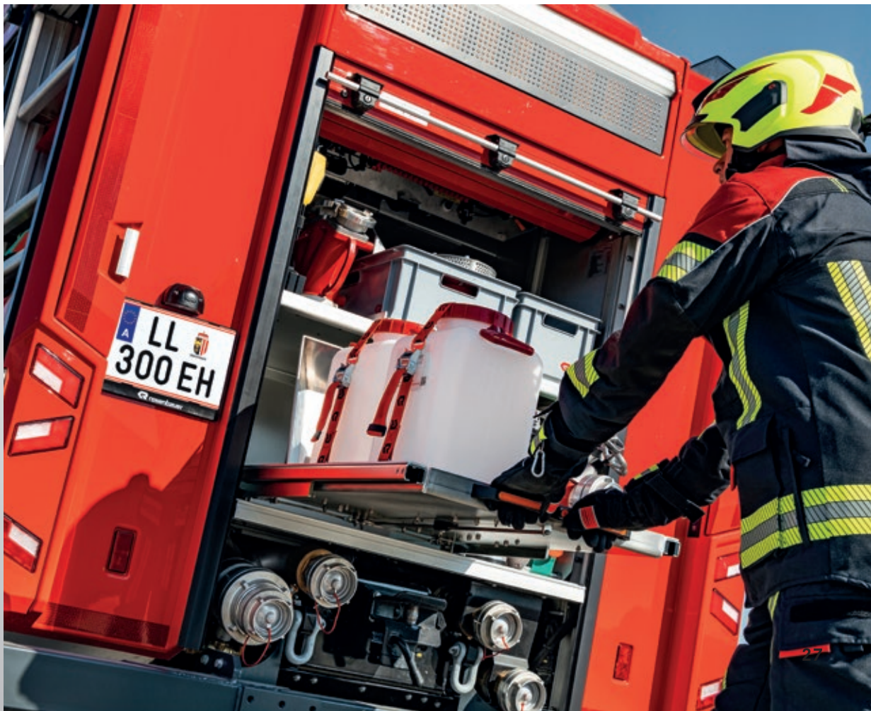
Zusätzlicher Laderaum im Heck dank nach vorne versetzter Pumpeneinheit.
