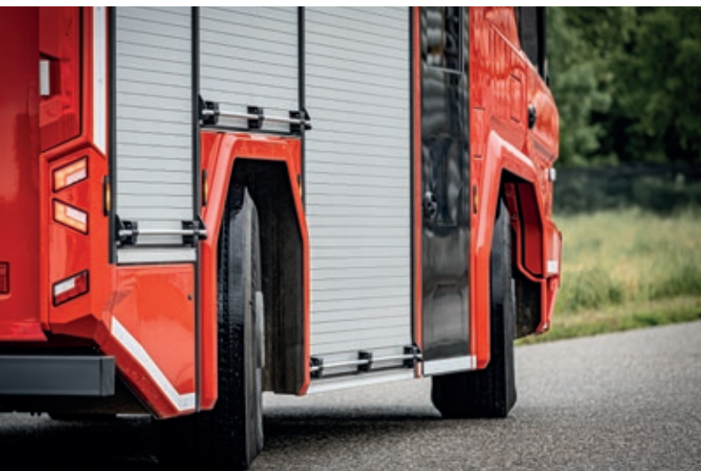
Parallelstellung der Räder beider Achsen für Manöver auf engstem Raum.
