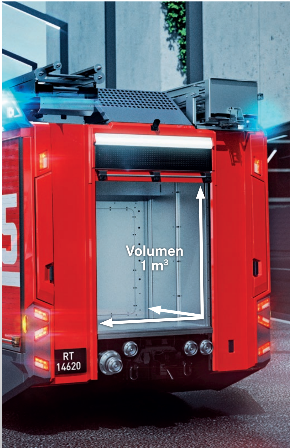
Zusätzlicher Laderaum im Heck dank nach vorne versetzter Pumpeneinheit.
